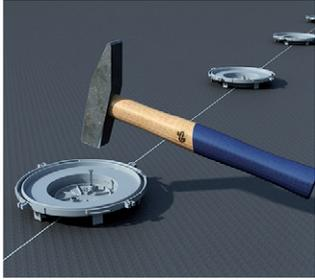
Frontteil auf der Schalung mit Nägeln befestigen. Nach dem Aufrasten des Gehäuses kann es zum Ausrichten um 360° gedreht werden.
