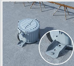
Gehäuse aufstecken und in die Kernbohrung setzen, anzeichnen und befestigen. Rohr in Kombinationseinführung M20/M25 installieren.
