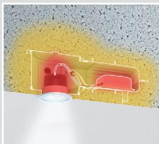
Die hohe Kontaktfläche der Gehäuse leitet die Wärme direkt über den Beton ab und vermeidet so zu hohe Temperaturen im Gehäuse.
